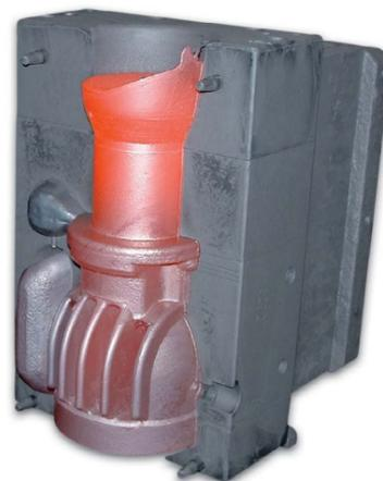
Gussteil aus Cu-C-GM beim Entformen auf Gießmaschine
