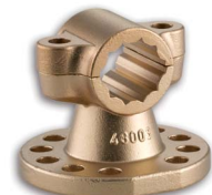
Klemmstück mit Deckel CuZn38Al-C-GM 0,420 kg und 0,100 kg für Verpackungsmaschinen
