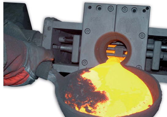
Gießen mit Gießmaschine
