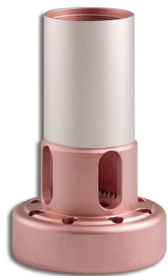
Beweglicher Kontakt, Cu-C-GM, 2,100 kg Kontakt für Hochspannungsanwendung partiell versilbert, Oberfläche nach dem Versilbern definiert kaltverfestigt
