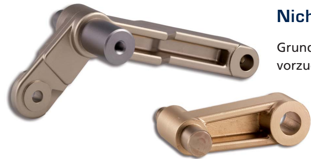
Schwenkhebel und Federhebel (vorne) jeweils mit eingegossenen Bolzen CuAl10Ni3Fe2-C-GM und CuZn25Al5Mn4Fe3-C-GM, 2,050 kg und 0,700 kg, für den Waggonbau und den Mittelspannungsschaltgerätebau
