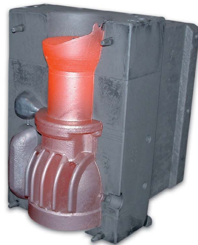
Gussteil aus Cu-C-GM beim Entformen auf Gießmaschine
