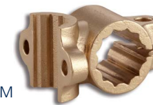
Klemmstück mit Deckel CuZn38Al-C-GM 0,420 kg und 0,100 kg für Verpackungsmaschinen
